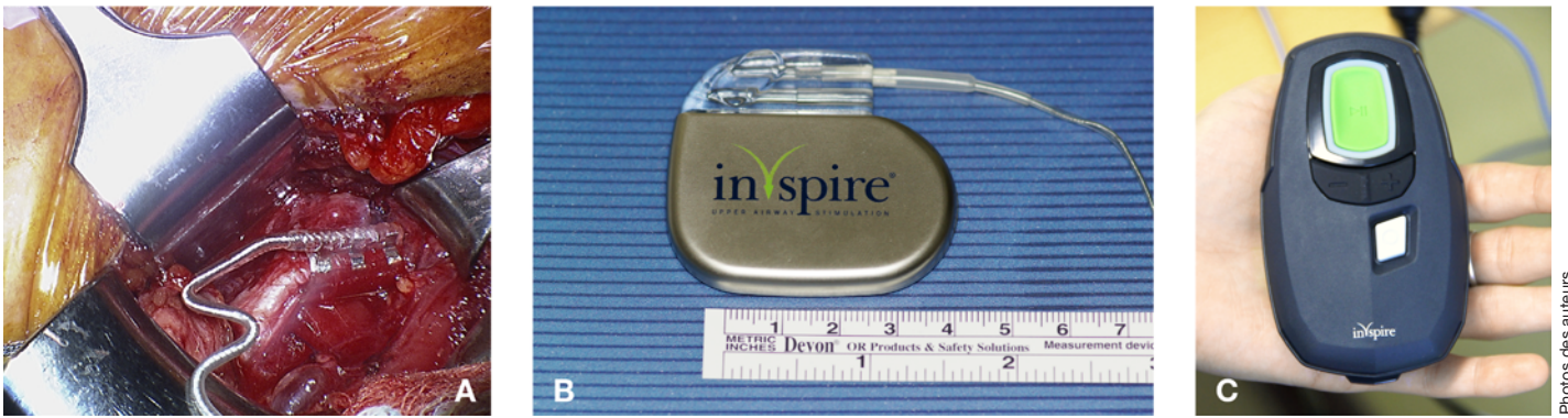
Figure 1: Système Inspire®: Electrode de stimulation sur le nerf hypoglosse (A), générateur d'impulsions (B), télécommande (C).
