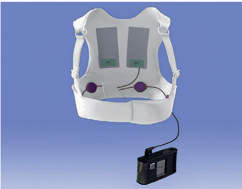
Abbildung 2: Tragbarer kardialer Defibrillator: Der «wearable cardioverter defibrillator» (LifeVest®, ZOLL Medical Switzerland AG, Zug) besteht aus einer Stoffweste, in der sich ein Gürtel mit Mess- und Therapieelektroden befindet, und einem Monitor.
