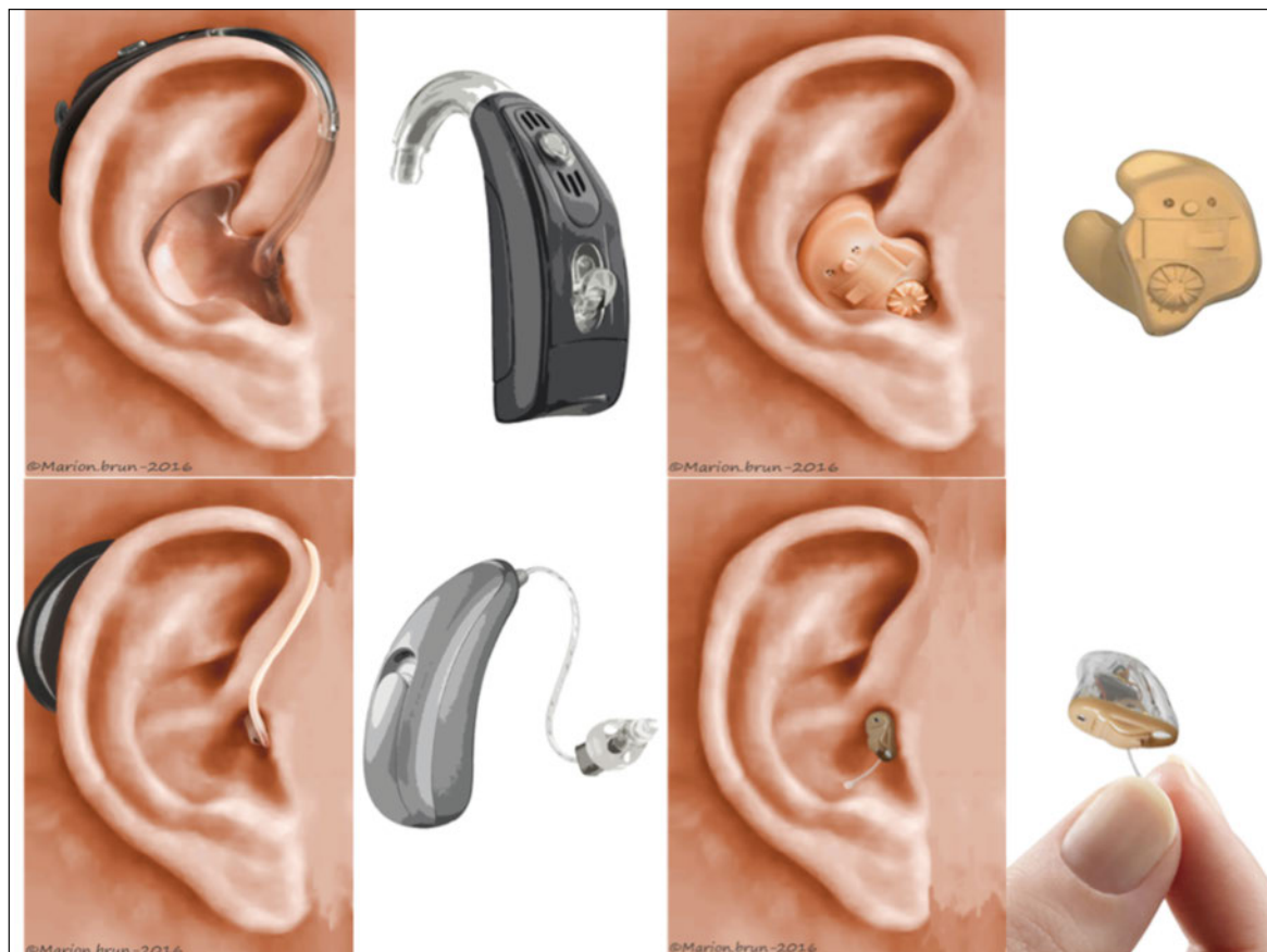
Abbildung 4: Derzeitige Hörgerätearten: Hinter-dem-Ohr-, Mini-Hinter-dem-Ohr-, Im-Ohr-Hörgeräte und Gehörgangsgeräte (© Marion Brun – 2016).
