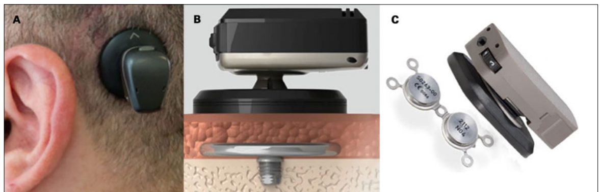
Figure 6: Appareils à conduction osseuse avec système magnétique, A+B) Baha® Attract de Cochlear™ (reproduction avec l'aimable autorisation de Cochlear Ltd) et C) Sophono™ de Medtronic (reproduction avec l'aimable autorisation de Medtronic, Inc.)
