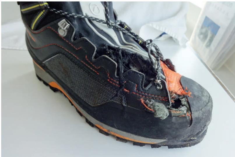
Abbildung 1: Materialdefekt des Schuhs.
