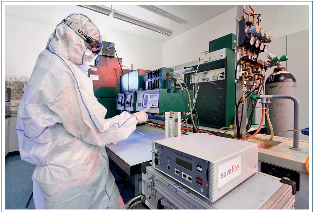
Abbildung 1 Tragbares Messgerät zur Messung von Nanopartikeln am Arbeitsplatz.
