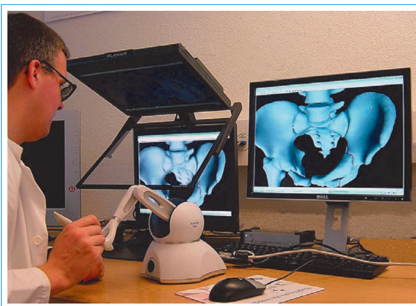
Figure 1 Une place de travail avec son écran stéréoscopique et son instrument haptique.
