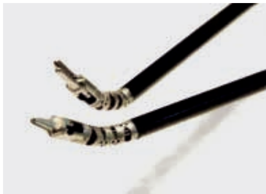
Abbildung 1. Roboterinstrument mit freier Beweglichkeit in alle Richtungen.
