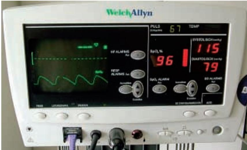
**Abbildung 2.** Multifunktionales Überwachungsgerät: Bei Kurznarkosen und Analgosedation während diagnostischen Eingriffen werden Puls, Pulsoximetrie, Pulskurve und Blutdruck gemessen.
