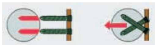
Abbildung 2. Winkelstabile Schrauben, die gekreuzt eingebracht werden, erhöhen die Ausreisskraft.
